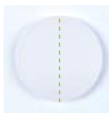
Variolink Esthetic Испытание на устойчивость к солнечным лучам (в соответствии с нормами ISO4049). Левая половина засвечена
